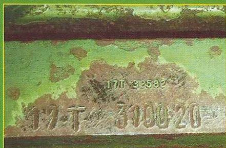
Nummernsalat: Die kleine eingeschlagene Nummer ist die amerikanische Bezeichnung, die große darunter gilt für den deutschen Markt.
