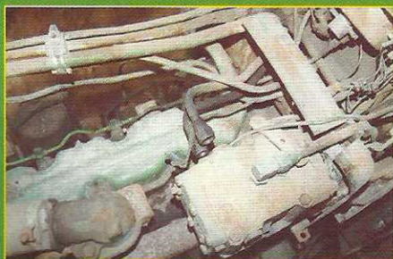
Theoretisch vorhanden: Das Zusatzsteuergerät war zwar am Platz – doch nicht angeschlossen.
