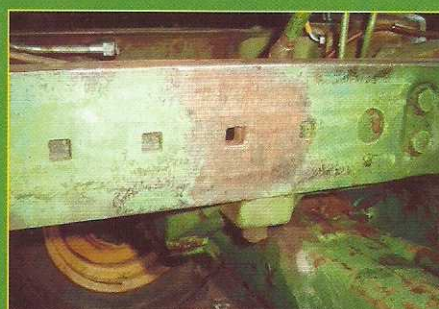
Kapitaler Bruch: Der Rahmen des 3010 gab im Vorleben auf und wurde repariert.
