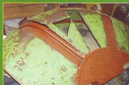
Hilfskonstruktion: Toralf Weber rettete die noch brauchbaren Kotflügel-Segmente und trennte den Rest heraus.
